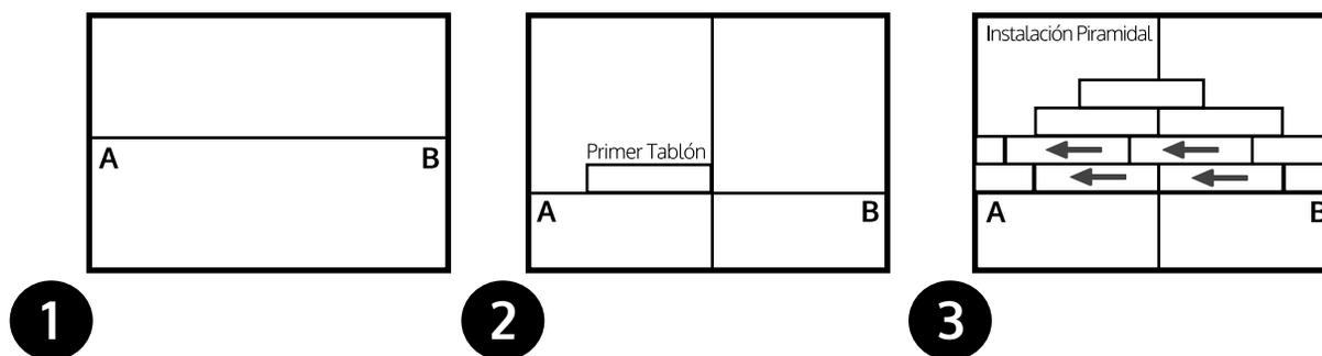
4. Ajuste las líneas de diseño según sea necesario para minimizar los tablonos perimetrales de menos de 6 ". Asegúrese de que las líneas sean cuadradas y luego trabaje desde las líneas de diseño del centro hacia afuera.
